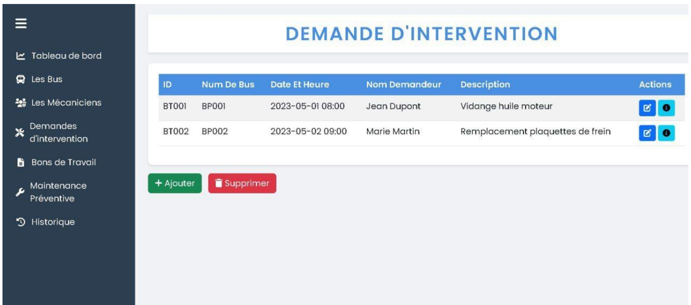
Figure IV .4 : Interface de demande d'intervention
