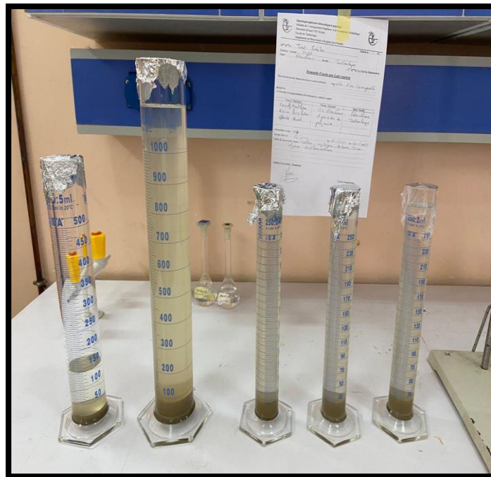
Figure 0-8 La séparation de phase dans l'étape de purification
