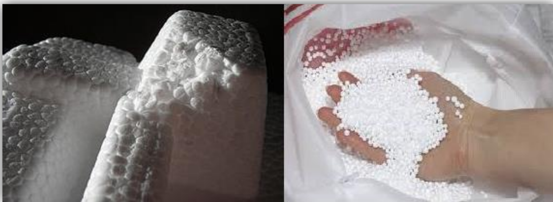
Figure 0-9 Polystyrène expansé blanc destinées un matériau utilisé à la fois dans le bâtiment, l'agroalimentaire et la logistique [20].
