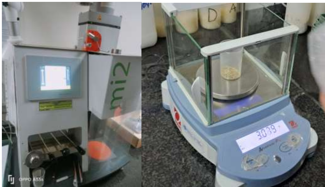
Figure IV.6: Illustration du protocole expérimental de l'indice de fluidité
