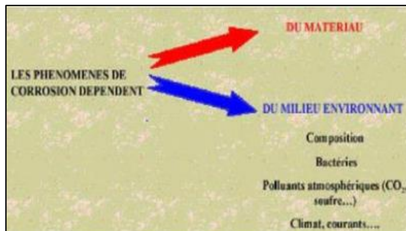
Figure I-1 : La nature des paramètres dus à la corrosion
