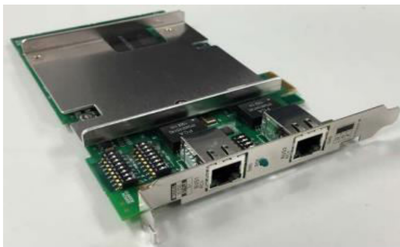
Figure III.7. La carte réseau Vnet/IP (Modèle : VI702)
