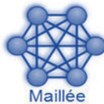
Figure IV.3. Topologie réseau maillé
