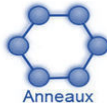
Figure IV.1. Topologie réseau anneau
