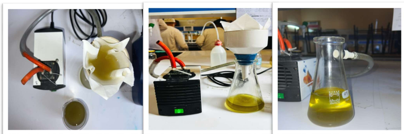
Figure II.8 : Filtration de l'inhibiteur.
