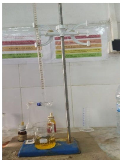
Fig. 11- Dosage du titre alcalimétrique complet (TAC).
