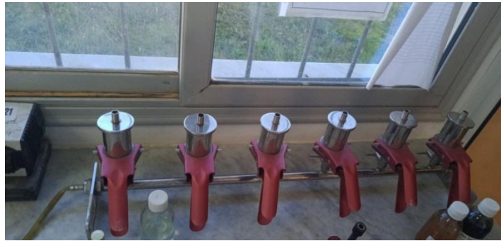
Fig. 18- Pompe de filtration
