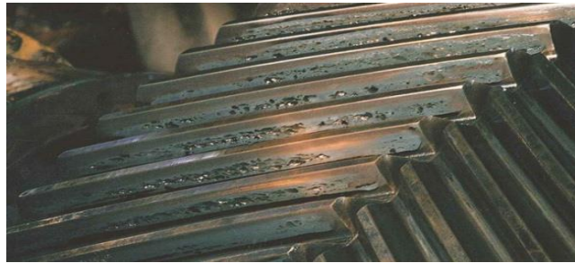
Figure II.4 défaut de piquage des dents
