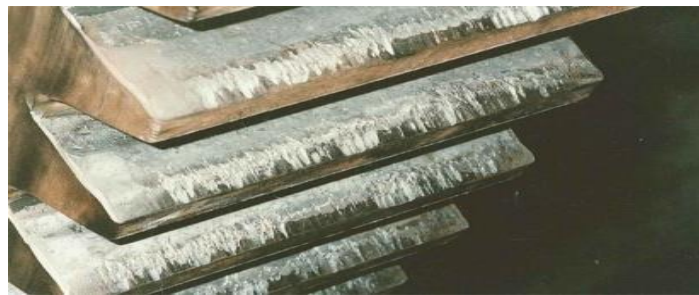
Figure II. 5 défauts de grippage des dents
