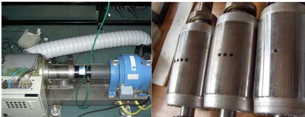
Figure IV.6 Moteur 5.5 [kW] accouplé à sa charge
