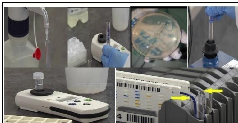
Figure .20: Les différentes étapes de la réalisation d'un antibiogramme automatisé par Vitek2.
