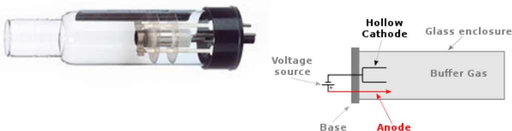
Figure 20 : Schéma d'une lampe à cathode creuse
