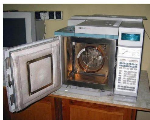
Fig. 25 : Vue de l'intérieur du four avec la colonne chromatographique
