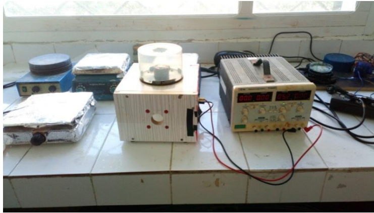
Figure III.3. Montage pour la centrifugation de la solution utilisée (montage disponible à l'université de Jijel)
