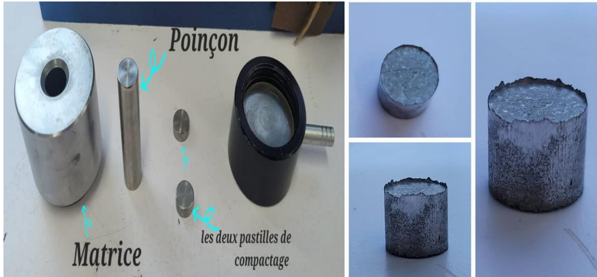
Figure II.4. Prise photo de la pastille compactée et les éléments du dispositif de compactage.
