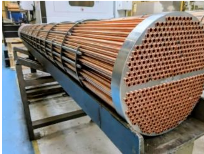
Figure -IV-5- Exemple d'un faisceau de tubes d'un échangeur encrassé [4].
