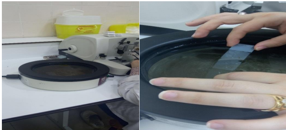
Figure 12 : Réalisation des coupes par le microtome (photo personnelle 2024).
