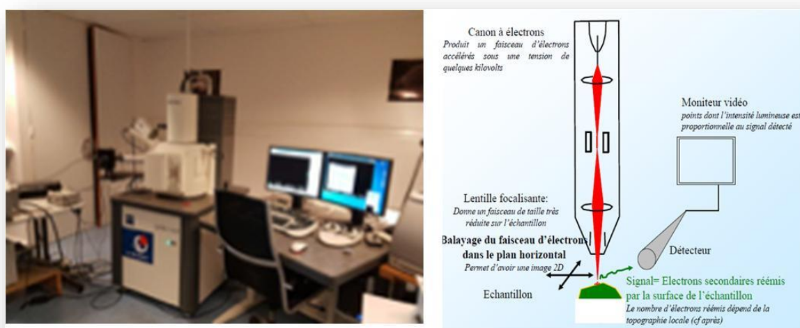
Figure II-12 : Microscope électronique à balayage ainsi que son principe de fonctionnement.
