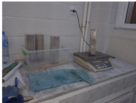
Figure 2.17 : Essai d'absorption d'eau par capillarité
