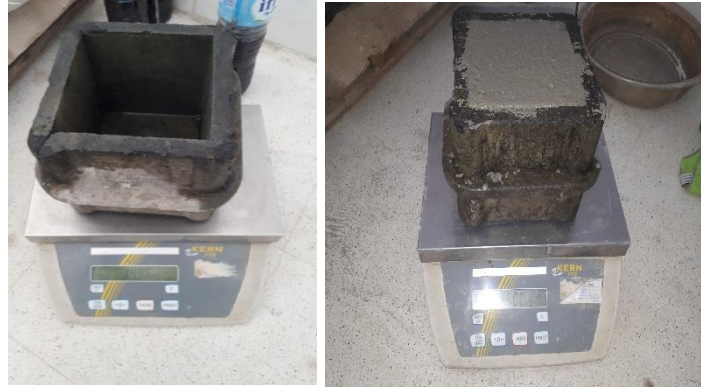
Figure 2.9 : Mesure de la densité du béton frais
