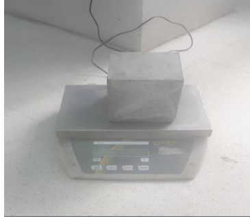
Figure 2.11 : Mesure de la densité du béton durci
