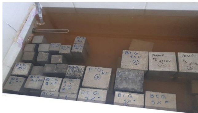
Figure 2.7 : Conservation des échantillons de BDP après démoulage
