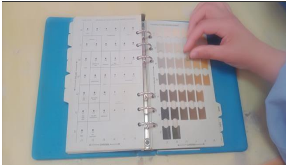
Figure 05 : La couleur d'un sol est codée par comparaison avec le nuancier de Munsell (Munsell Soil Color Chart).
