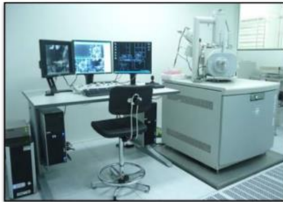
Figure II.7 : Microscope électronique à balayage type «FEI – QUANTA 200» équipé d'un système d'analyse EDS.
