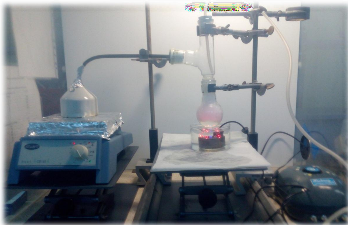
Figure II.13: Dispositif complet de la technique Spray ultrasonique.
