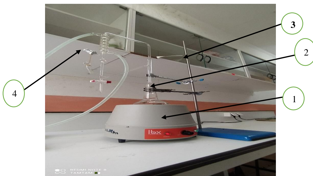
Figure 14 : montage utilisé pour l'hydrodistillation (originale,2022).
