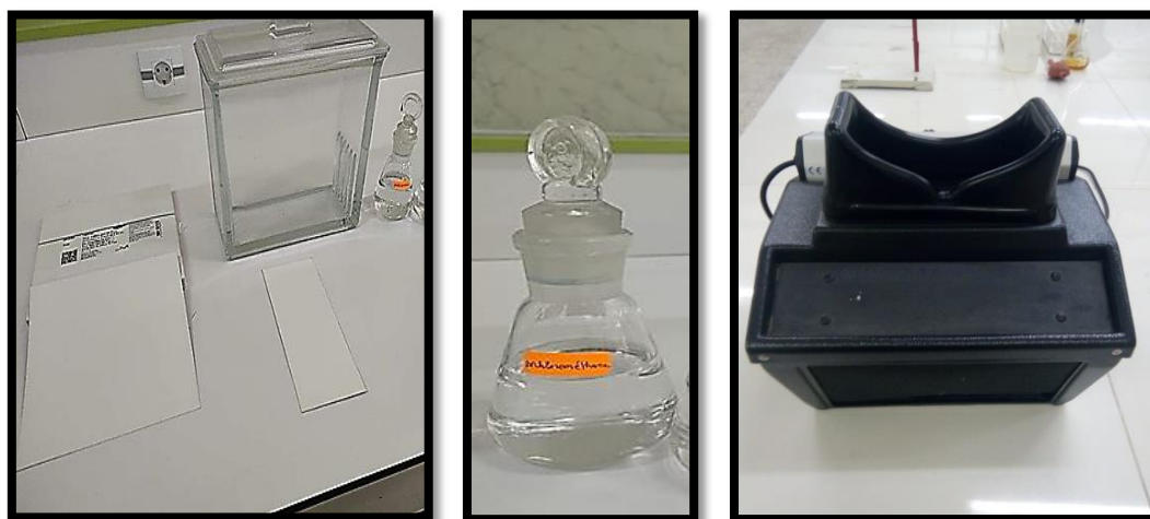
Figure n° 12: Matériel de la chromatographie sur couche mince (Photo personnelle).
