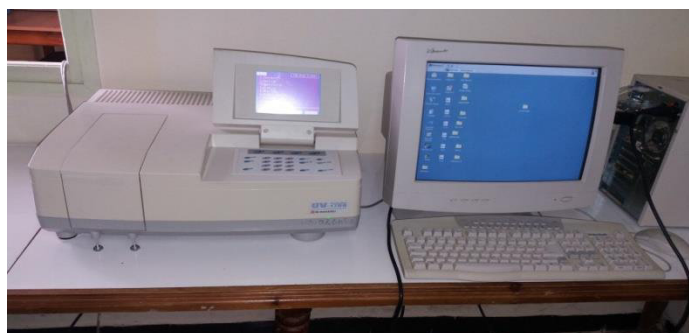
Figure III.5: Image réelle du spectrophotomètre UV-visible Shimatzu 1700.
