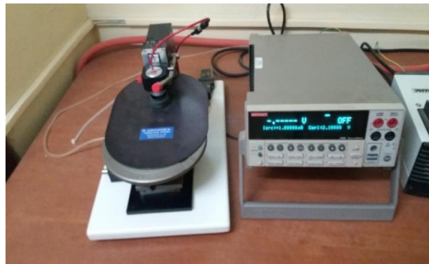
Figure III.3 : Image réelle du soucemètre Keithley 2400.
