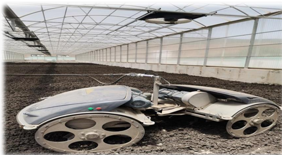
Figure III.16 : Le Sanglier électrique le (racleur –laboureur).
