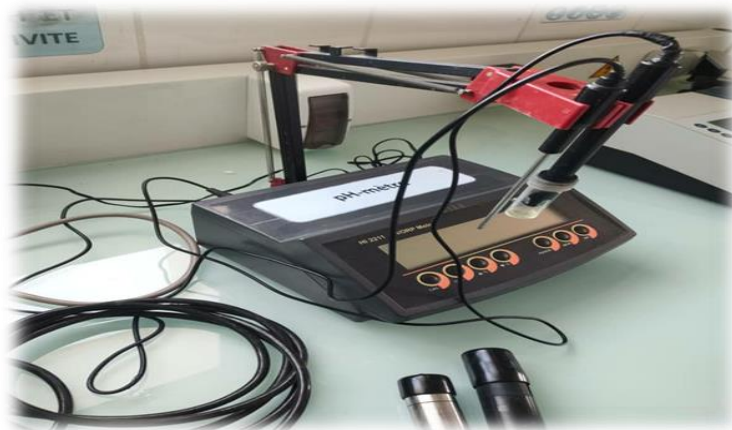
Figure IV.4 : pH Mètre de mesure multiple (pH/ conductivité / température)
