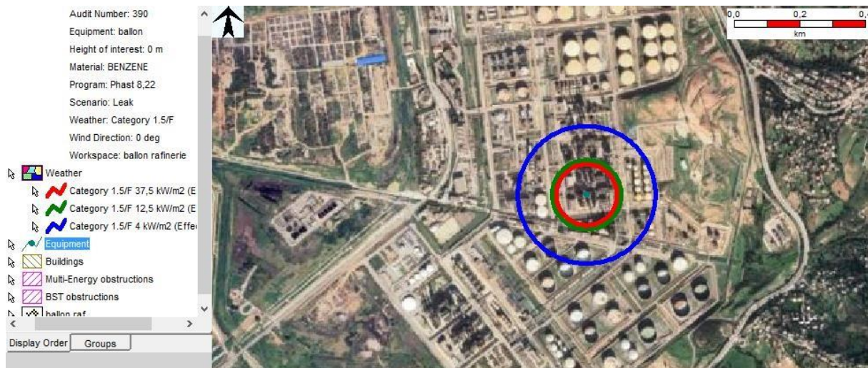
Figure III.19: Intensité des radiations pour le feu de nappe précoce (early pool fire).
