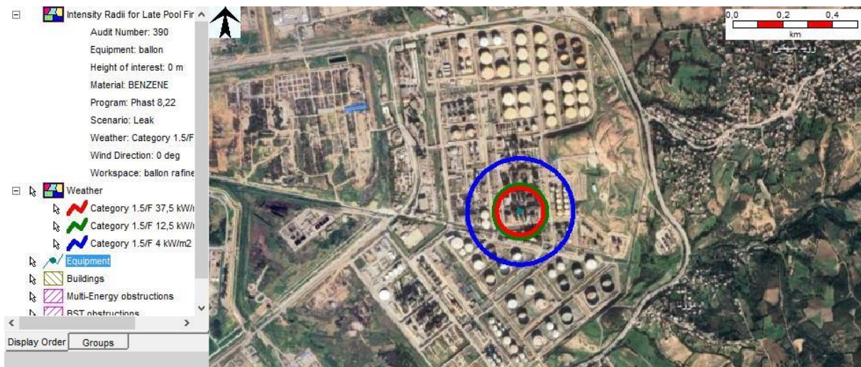
Figure III.20: Intensité des radiations pour le feu de nappe tardif (late pool fire).
