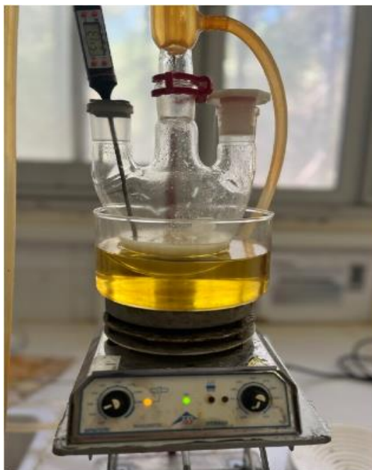
Figure III.20: Montage de la réaction de transestérification (CaO).
