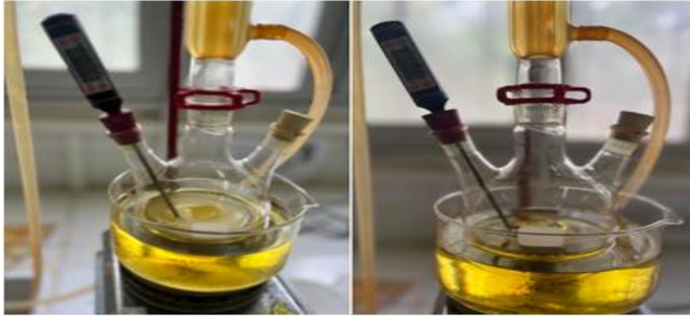
Figure III.16: Montage de la réaction de transestérification (KOH/NaOH).
