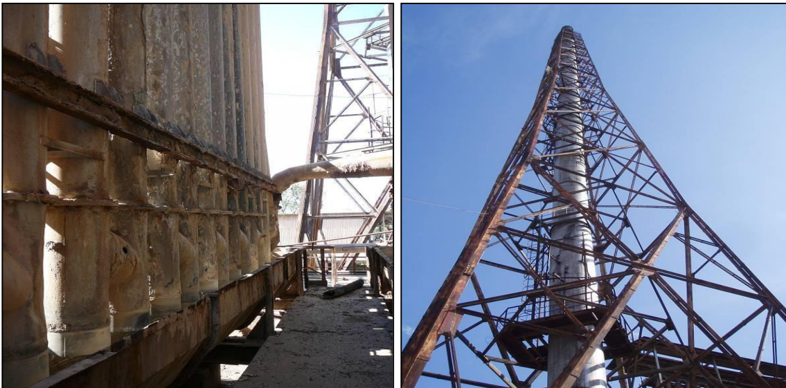
Figure 07.à gauche : condenseurs et goulotte de récupération du mercure. A droite : cheminée.
