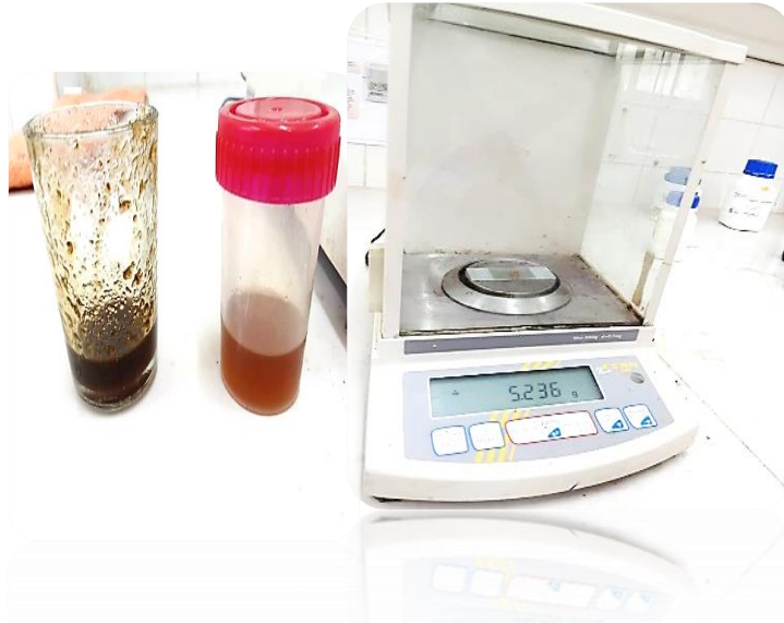
Figure 28 : Peser le miel avec une balance analytique.
