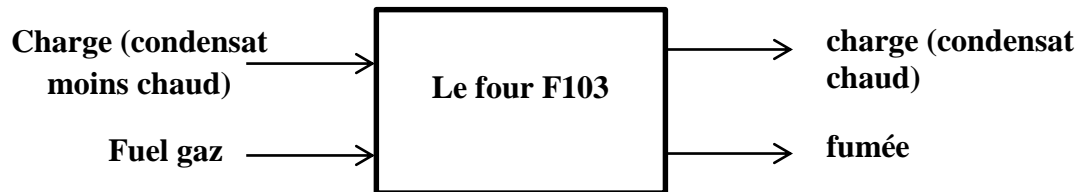
Figure III.1 Schéma d'entrée et de sortie dans le four F103
