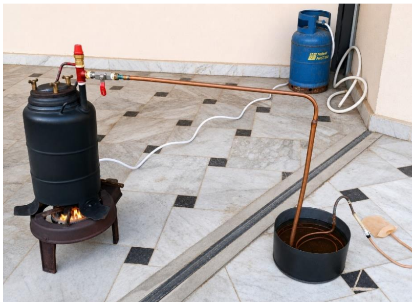
Figure III-2 : Dispositif de pyrolyse de bois.
