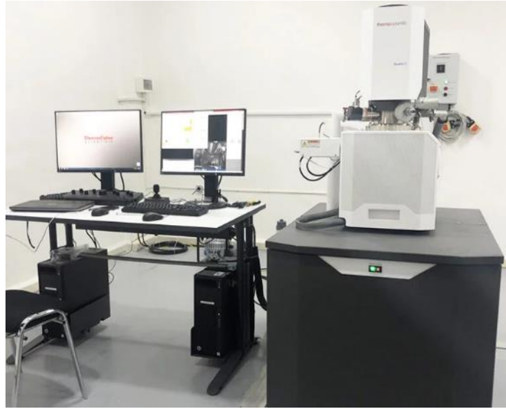
Figure III.10. Microscope électronique à balayage à canon à émission de champ (FEG-MEB) (Quattro S) couplé d'une spectroscopie de rayons X à dispersion d'énergie (EDX).
