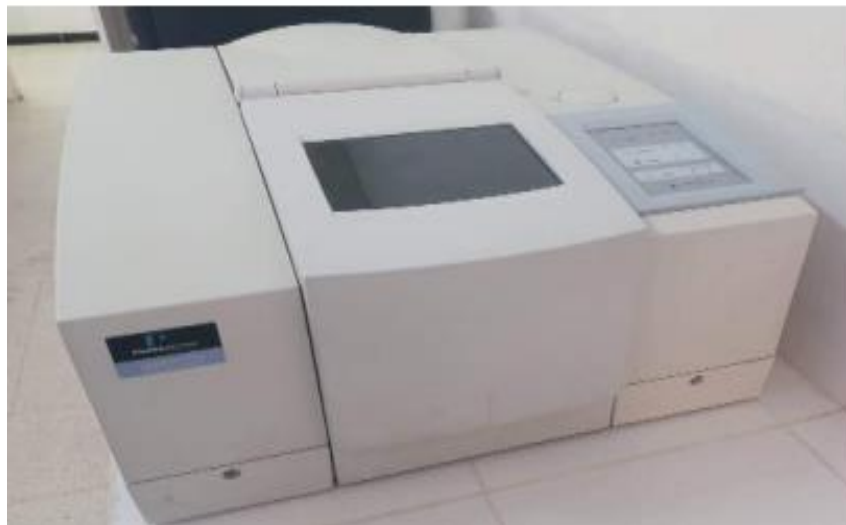
Figure III.12. Spectromètre IRTF Perkin Elmer.
