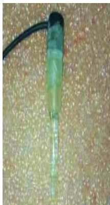
Figure III.6. Photographie de l'électrode de référence (Ag/AgCl/ KCl) [LAIGM].
