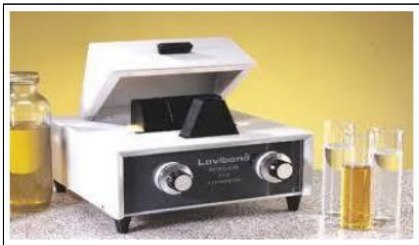
Figure III.21 : L'appareil de Colorimètre Lovibond [49].
