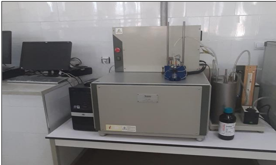
Figure III.26: analyseur de température limite de filtrabilité (CFPP) [52]
