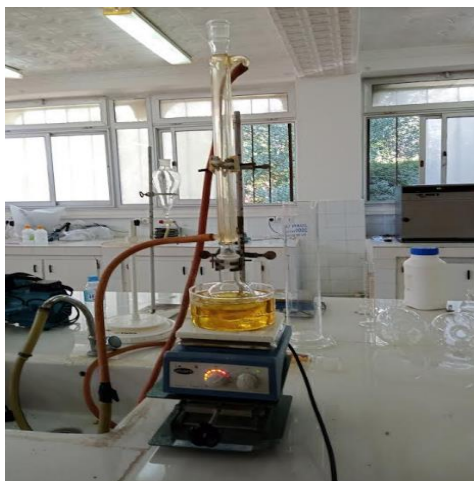
Figure III.2 : Montage à reflux
