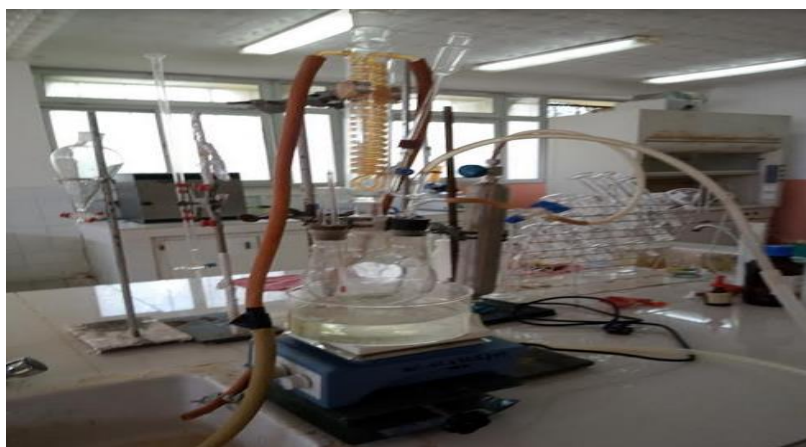
Figure.I.1 : dispositif pour la synthèse du copolymère
