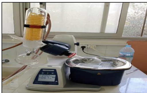
Figure III.6 : Rotta-vap pour la purification des monomères
