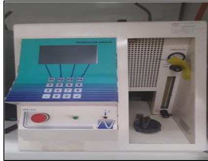
Figure III.24 : analyseur de carbone Conradson RCC[55].
