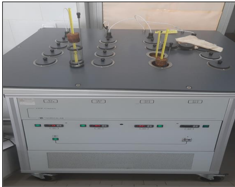
Figure III.20 : L'appareil de mesure du point d'écoulement [47].
