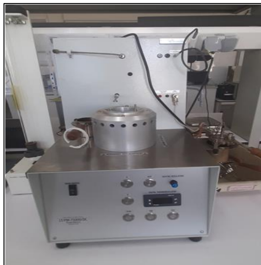
Figure III.23 : Analyseur du point d'éclair vase clos [56].
