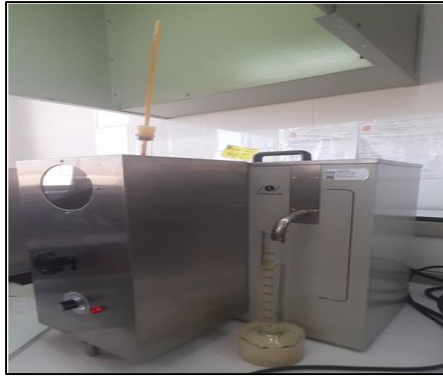
Figure III.18 : L'appareillage de la distillation ASTM D 86. [50]
