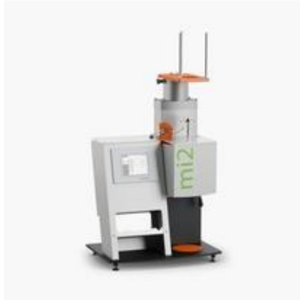
Figure III.1. Photo de plastomère utilisé dans l'analyse l'indice de fluidité.
