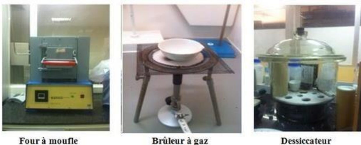
Figure III.9. Séries des photos du dispositif utilisé dans l'analyse de la teneur en cendre.
