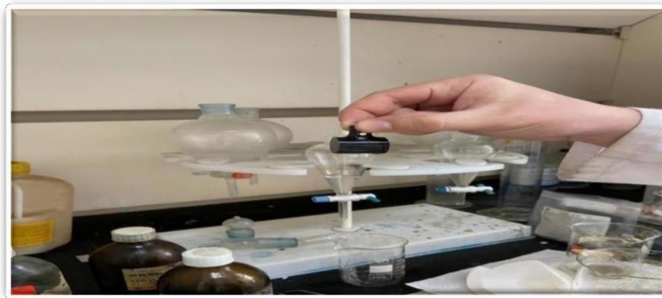
Figure 17 : Cellule de l'analyseur de l'hydrocarbure
