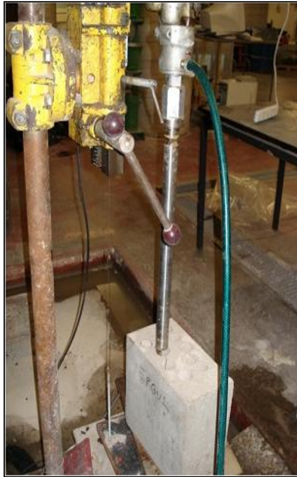
Figure III. 4 : Photo de l'installation de laboratoire pour les expériences de forage
