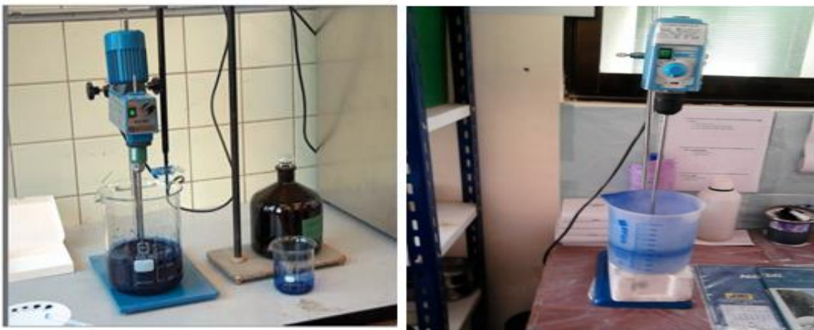
Figure 3.6 : appareillage de l'essai bleu de méthylène. (Laboratoire de LNHC)
