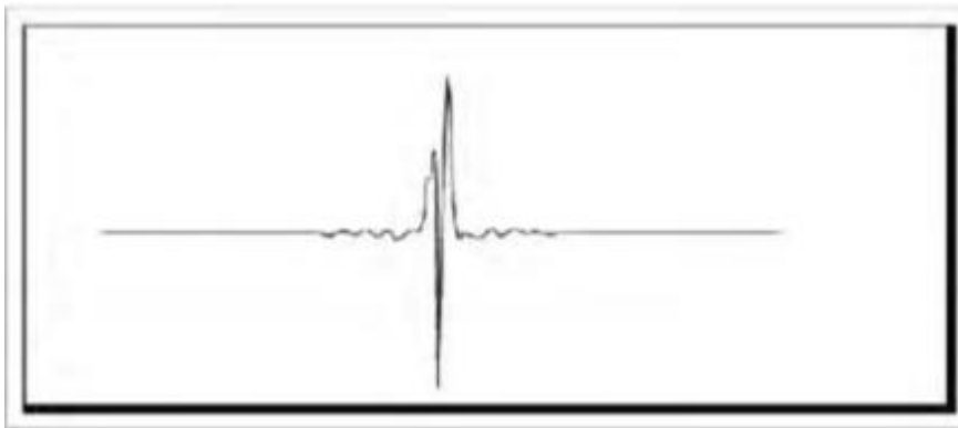
Figure II.12. Interférogramme en sortie du détecteur.
