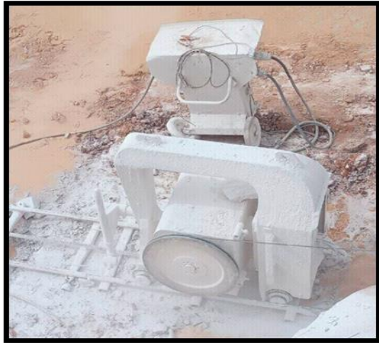
Figure 8. La machin diamantée lors de travailler.
