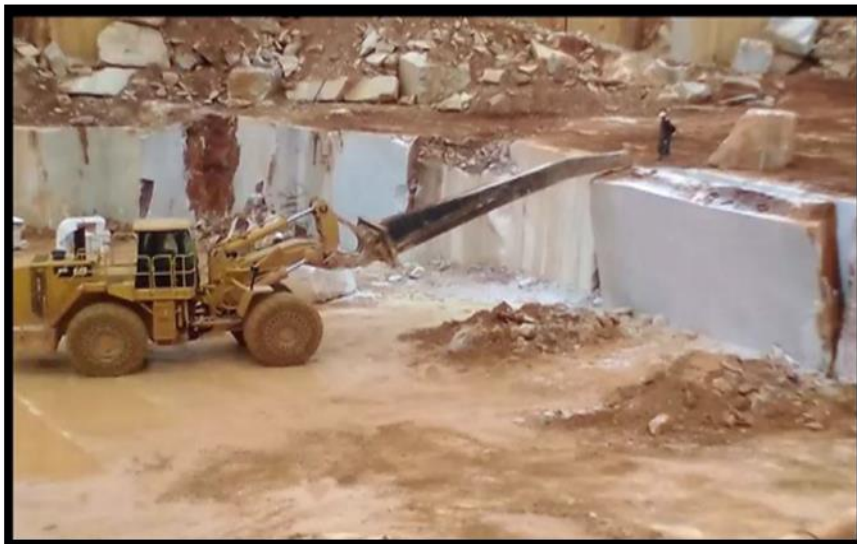
Figure 9. La préparation du matelas (Semassel et souilah, 2018).
