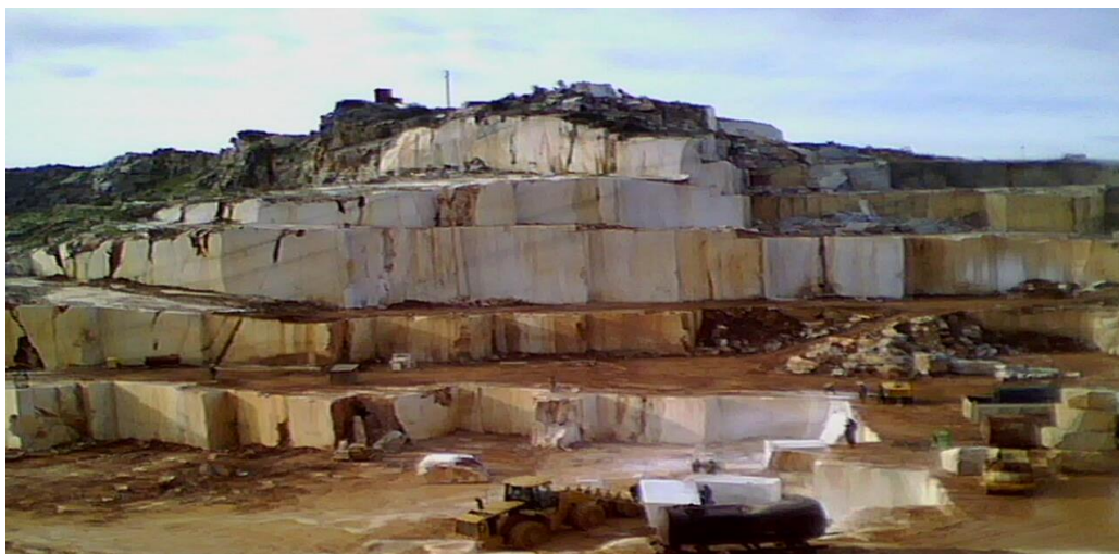
Figure 4. Les gradins d'exploitation dans la carrière de Filfila
