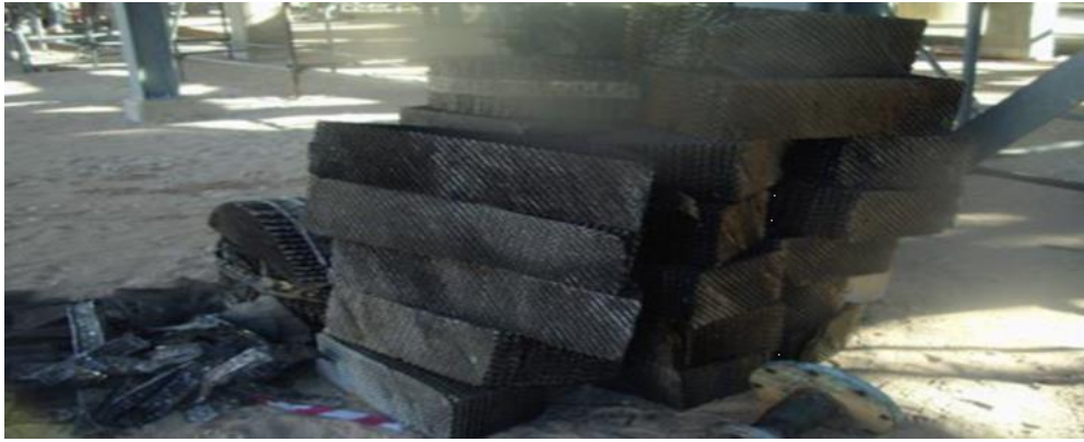
FigureIII-22: L'état du garnissage de la colonne(25)
