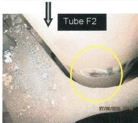
Figure IV. 5 : Usure des tubes par friction en 2016, Four 100-F-103 [44]
