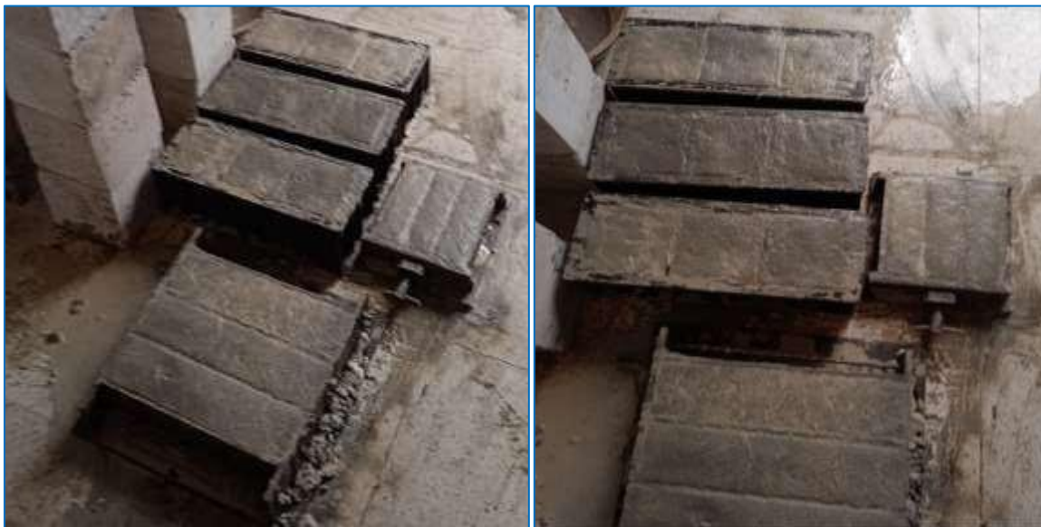
Figure III.5 : Conservation des moules remplis par le béton
