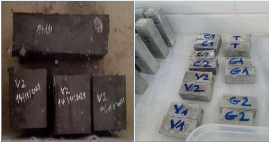
Figure III.6 : Décoffrage des éprouvettes.
