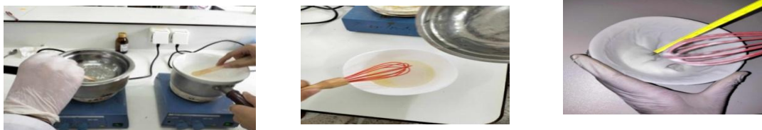
Figure 25: Versement de la phase aqueuse sur la phase huileuse pour obtenir l'émulsion.
