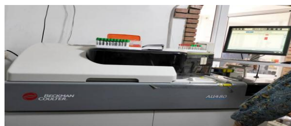
Figure 33 : Automate des analyses biochimique modèle BECKMEN COULTER-AU480 (photo originale).
