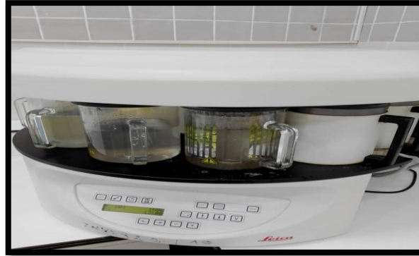
Figure 36 : Automate pour la circulation (photo originale).
