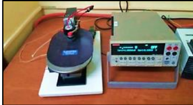
FIGURE III.5: Photo réelle de la source mètre Keithley 2400
