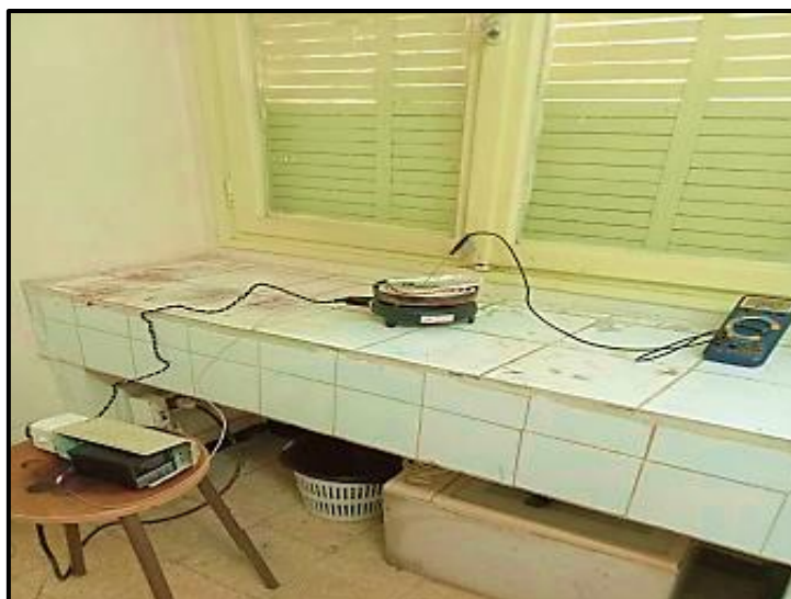
FIGURE III.2: Montage réel du spray pyrolyse monté au laboratoire LRPCSI de l'université de Skikda.
