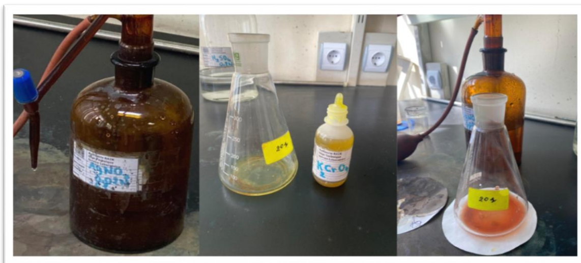
Figure III.4 : des équipements et produits utilisés dans la détermination du Cl -
