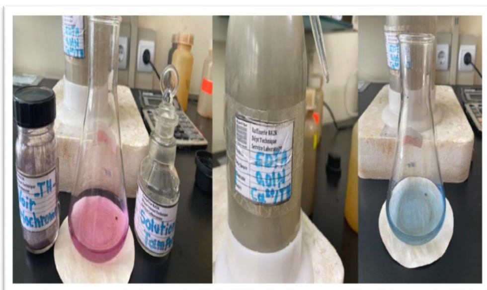
Figure III.6: Des équipements et produits utilisés dans la détermination de la dureté totale (TH)
