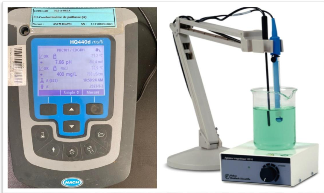
Figure III.3 : PH mètre avec chaîne d'électrode en verre calomel
