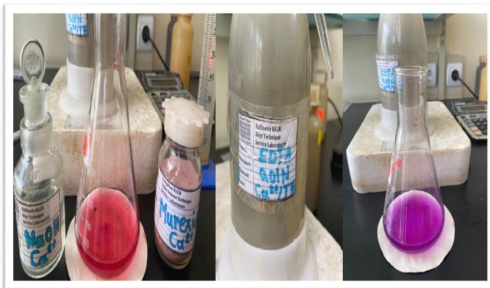
Figure III.7: Des équipements et produits utilisés dans la détermination du calcium.
