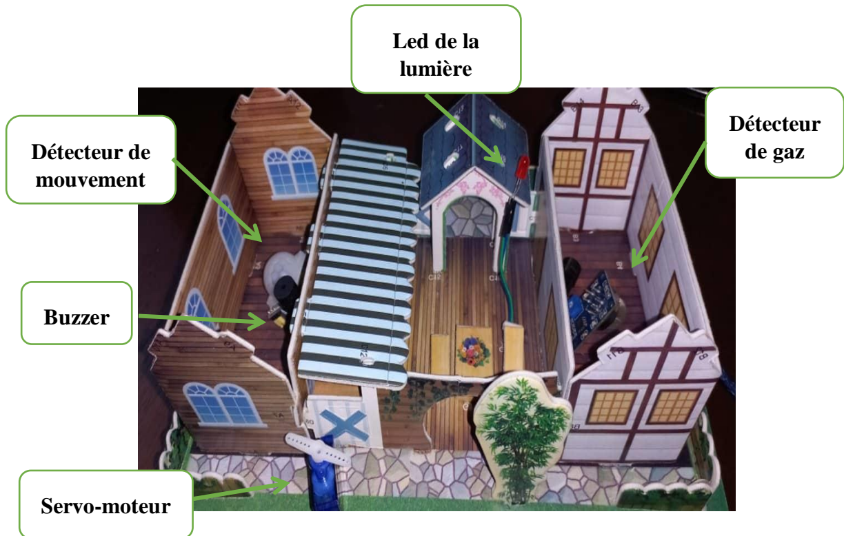
Figure 75 : Vue de haut de la maquette avec tous ses composants.
