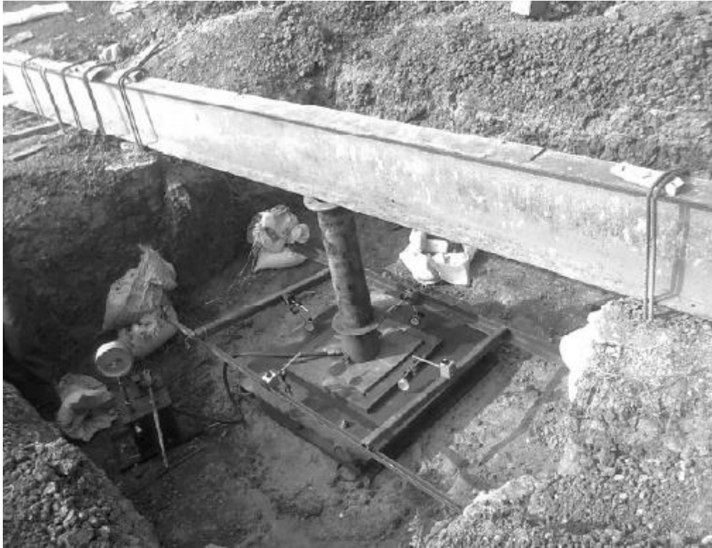
Fig I.22. La disposition de test pour le test de semelle à grande échelle (d'après [106]).
