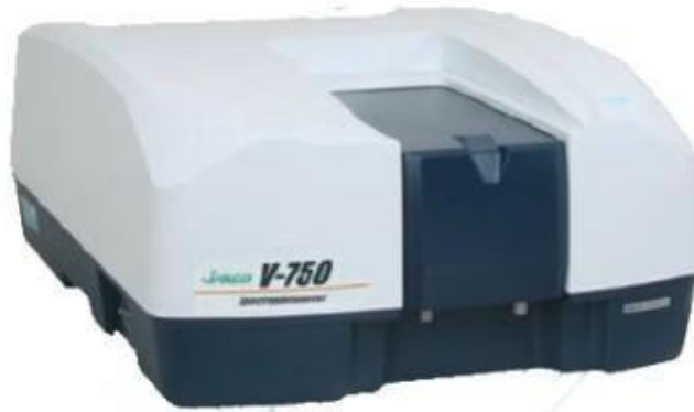
Figure.III.14 : Présentation du spectrophotomètre UV-Visible (Laboratoire composants actifs et matériaux, Université Oum El Bouaghi)
