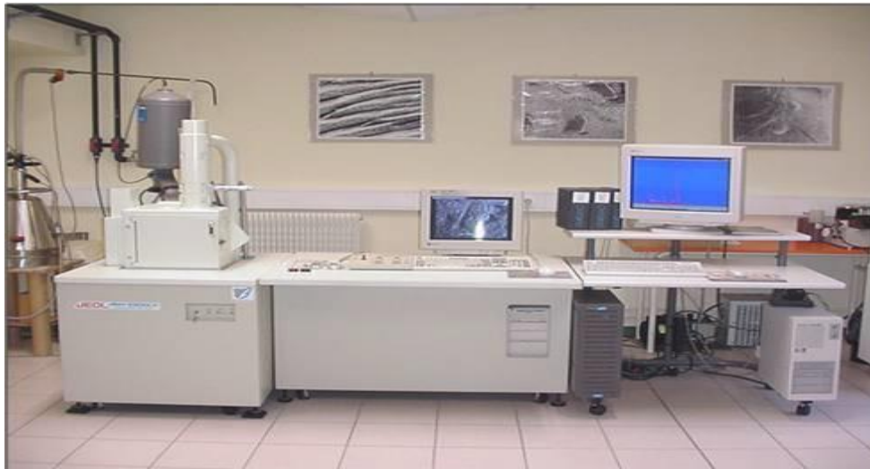
Figure III.13 : Photographie du microscope électronique à balayage
