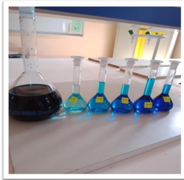
Figure IV.19: Solution mère et solution filles de vert malachite
