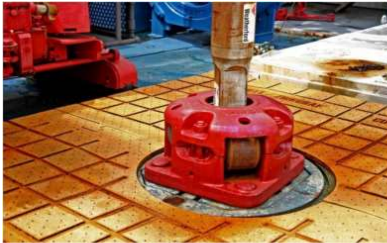
Figure I.2. L'ensemble table de rotation et tige d'entrainement (Kelly) [11].
