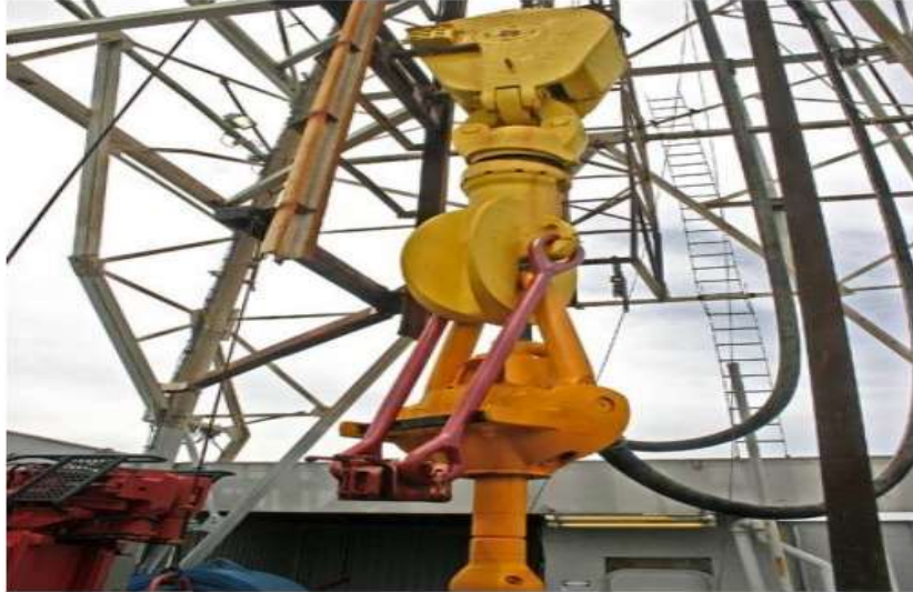
Figure I .1. Moufle fixe et rochet [1].
