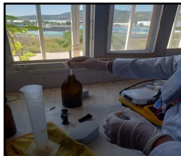
Photo 15, 16, 17. Protocole la demande biochimique en oxygène sur 5 jours (DBO 5 ) (Photos
