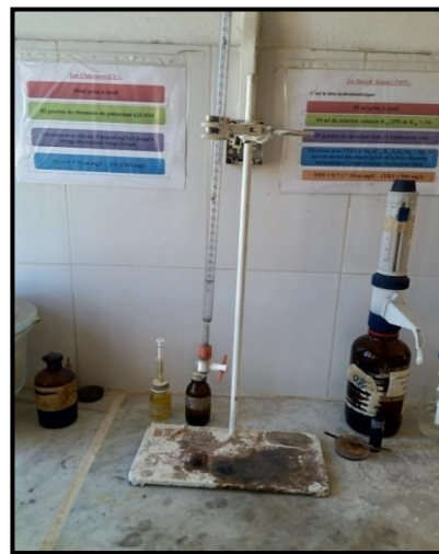
Photos 6 et 7. Protocole de dosage des chlorures (Photos personnelles)
