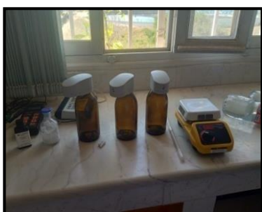
Photo 15, 16, 17. Protocole la demande biochimique en oxygène sur 5 jours (DBO 5 ) (Photos
