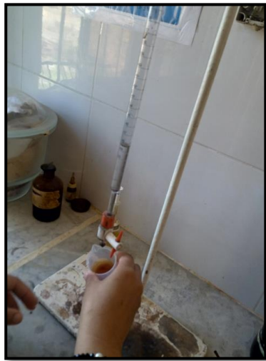
Photos 6 et 7. Protocole de dosage des chlorures (Photos personnelles)
