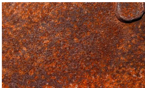
Figure II.1 : Forme de la corrosion uniforme
